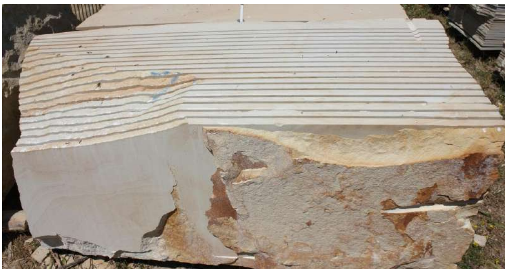
Рис.2 Блок ямпільського пісковика розрізаний на сляби, родовище Червоний берег-1
