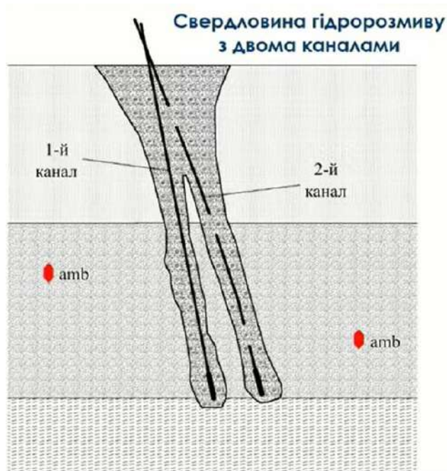
Рис.4. Профіль свердловини, отриманий гідророзмивом за даними [5]
